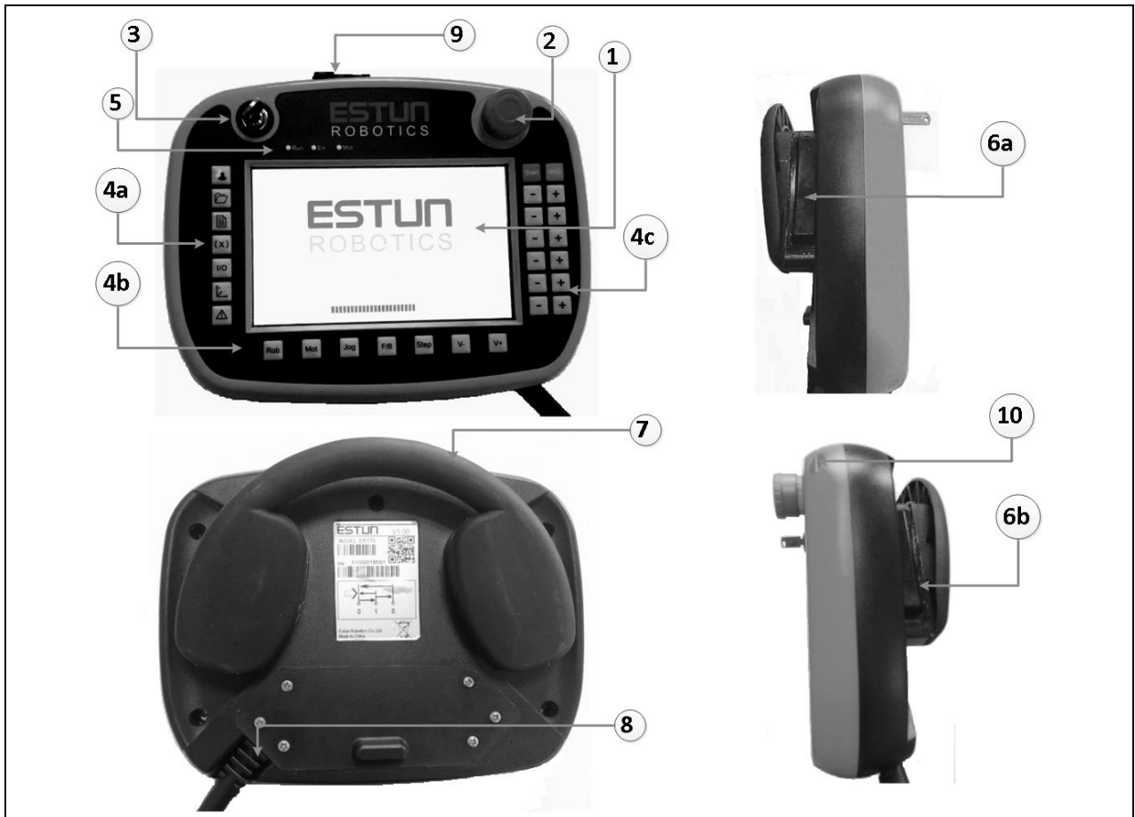
图 1.4 ESTUN 示教器按钮示意图
