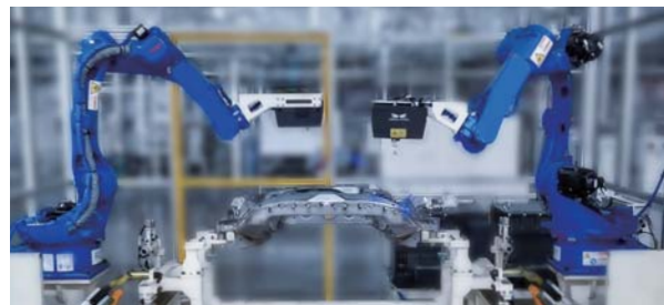
某大型汽車主機廠 副車架在線測量
