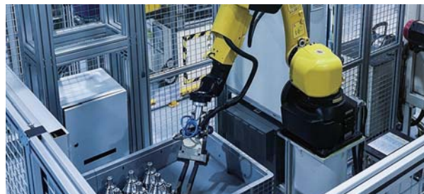
某大型汽車零配件廠 視覺引導外星輪抓取上料
