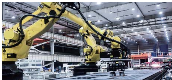
某工程機械巨頭 視覺引導鋼板切割下料
