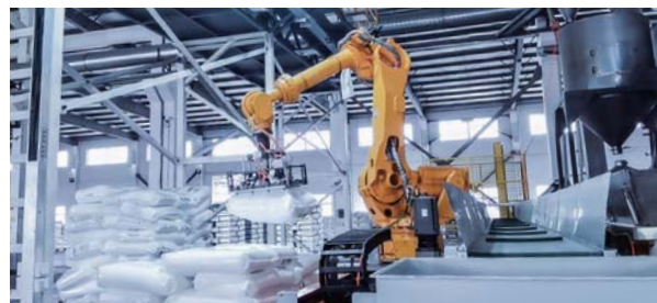
某大型化工廠 視覺引導麻布袋卸棧破包
