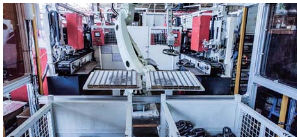
某工程機械巨頭 視覺引導鏈軌節深籃抓取上料
