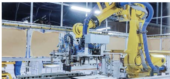
某大型汽車主機廠 視覺引導電池模組上料
